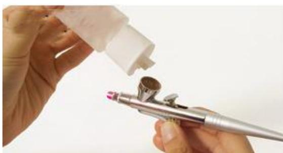
Теперь добавьте 5 капель теплой воды в чашу, чтобы заправить аэрограф.
