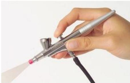
Аэрограф оставьте включенным. Выдуйте всю воду на салфетку или в раковину в ванной, распыляя ее аэрографом. Откройте дроссельную заслонку на аэрографе на максимальное распыление.
