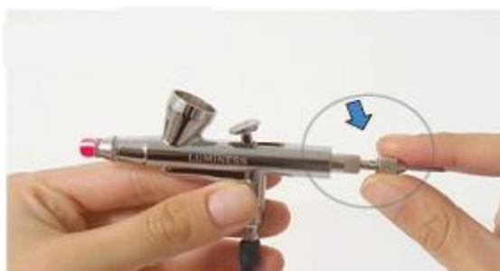
Ослабьте болт, закрепляющий иглу – достаточно всего лишь половины оборота. Не выкручивайте болт до конца; просто слегка ослабьте.
