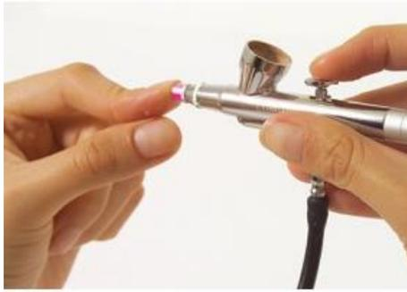
Включите аэрограф. Поместите указательный палец на сопло аэрографа, чтобы перекрыть поток воздуха. Аккуратно оттяните дроссельную заслонку аэрографа на 1/4, чтобы в чаше появились маленькие пузырьки. Промывайте в течение 8-15 секунд в зависимости от требуемого уровня очистки. Обратное мытье промывает и очищает аэрограф внутри.
