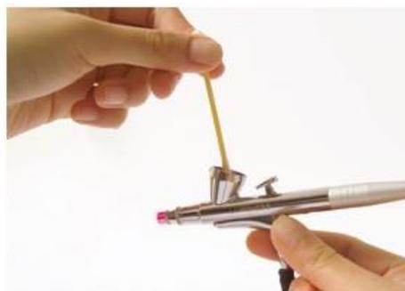
Удалите остатки макияжа/краски / чернил с аэрографа с помощью мягкой ватной палочки. Не давите слишком сильно на иглу аэрографа, проходящую через дно чаши, так как это может повредить аэрограф.
