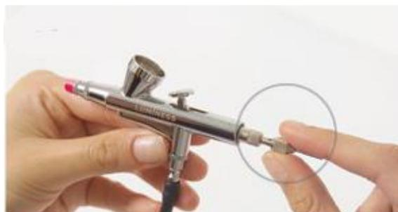
Затяните фиксирующий болт иглы до тех пор, пока игла не будет удобно закреплена. Не затягивайте слишком сильно.
