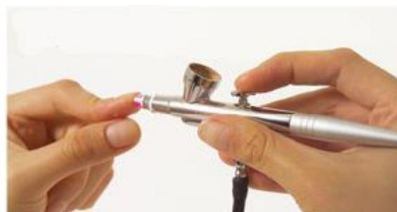
Промойте водой заднюю часть аэрографа, закрыв кончик указательным пальцем и оттянув дроссельную заслонку распылителя.
