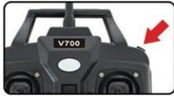
«Круиз-контроль» (движение с фиксированной скоростью): когда лодка продолжает двигаться вперед, нажмите и удерживайте кнопку круиз-контроля с фиксированной скоростью. Прикормочный кораблик перейдет в режим круиз-контроля и продолжит движение вперед без участия пульта дистанционного управления. Пульт будет постоянно медленно издавать короткие звуковые сигналы.
