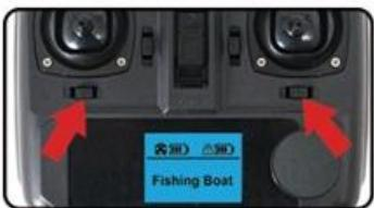
Кнопка подкормки: Нажмите левую кнопку подачи подкормки, чтобы опустошить левый бункер. И нажмите правую кнопку, чтобы опустошить правый бункер.
