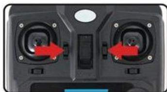
Точная регулировка скорости двигателя: нажмите вперед кнопку триммера левого винта. Левый мотор ускоряется, а правый замедляется. Нажмите назад триммер левого двигателя, тогда левый двигатель замедлится, а правый ускорится. Обе кнопки работают одинаково.
