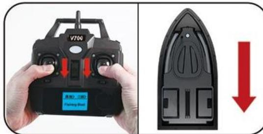
Чтобы лодка начала движение назад, сдвиньте оба джойстика назад.
